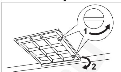
3. Utför proceduren i omvänt ordning när du ska installera ett filter.
