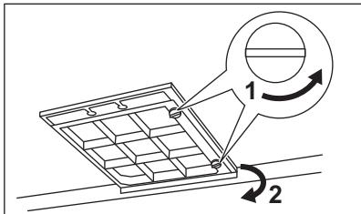
3. Voer dezelfde stappen in omgekeerde volgorde uit om een filter te installeren.
