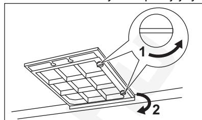
3. Při instalaci filtru provedte stejný postup v opačném pořadí.
