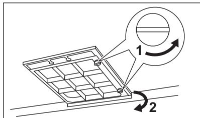
3. Führen Sie zum Einbau des Filters die gleichen Schritte in umgekehrter Reihenfolge durch.
